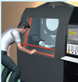
Rang 2 - Trennende Schutzeinrichtung
